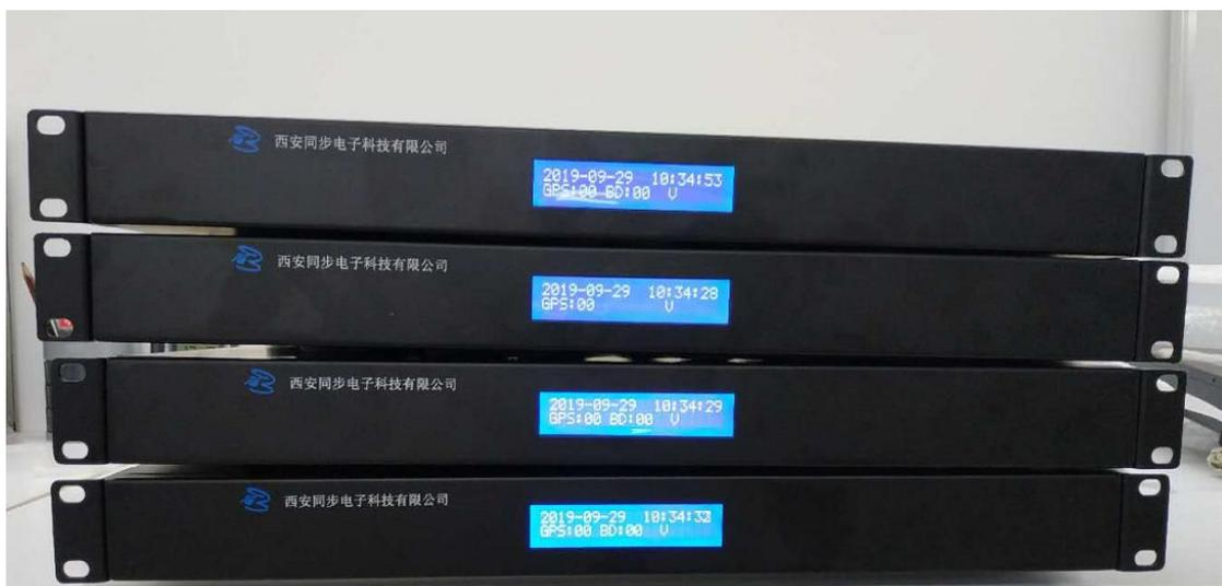
在基本条件下, NTP 客户端发出时间请求,与时间服务器交换时间。通常情况下,在设置的初始阶段每 5 分钟到 10 分钟内有 6 次交换;一旦同步以后,每十分钟与服务器时间进行同步一次,通常要求单一交换信息。
